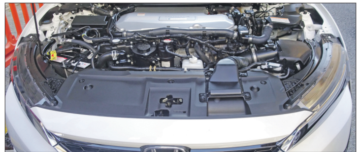
Die Brennstoffzelle leistet 300 NM Drehmoment bei 176 PS und hat eine Reichweite von etwa 700 Kilometer.
